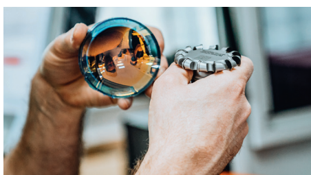
BOVEN: Een Julbo-lens, stap één. Het slijpklaar maken.
